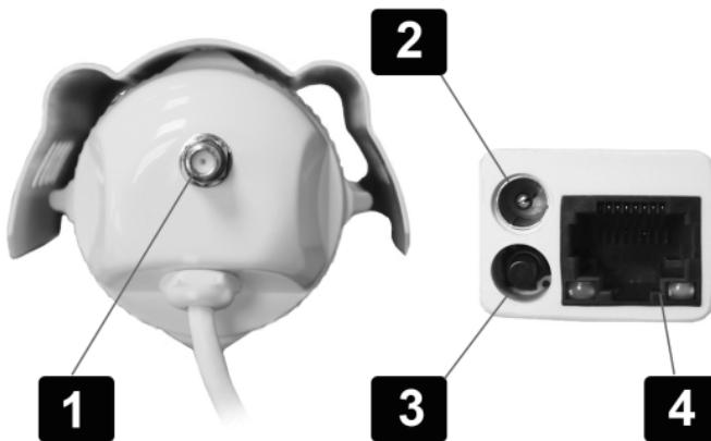
1. Разъем для подключения Wi-Fi антенны.
