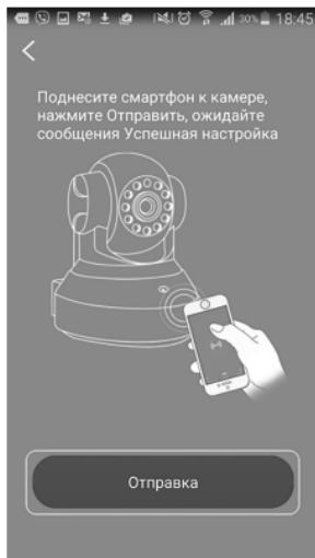
Ожидайте звуковое подтверждение успешного подключения камеры к сети Wi-Fi: **«Установка беспроводного подключения Wi-Fi - успешно»**. По окончании поиска выберите Вашу камеру по UID в списке и нажмите **«Подключение»** (UID находится на наклейке, расположенной на нижней стороне камеры):
