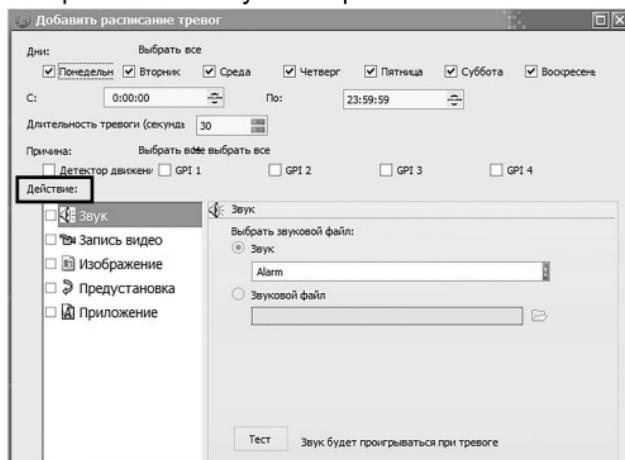
б) **запись видео** - начнется при стабатывании датчика движения:
