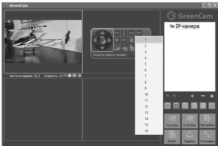
С помощью навигационных клавиш поверните камеру на предполагаемую вторую точку круиз-контроля. Нажмите кнопку **«Создать предустановку круиз-контроля»** и из выпадающего списка выберите пункт **«2»**:
